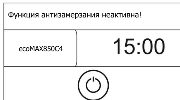
Рис. 8 Вид экрана контроллера в выключенном состоянии (режим STAND-BY), в котором функция антимерзания неактивна.
